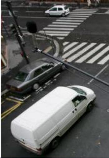
La diminution des niveaux sonores liée à la réduction des vitesses est variable selon la vitesse considérée. Il est généralement reconnu (*Guide Ademe pour l'élaboration des Plans de Prévention du bruit dans l'environnement, d'après la NMPB route 2008*) qu'une diminution de vitesse de 10 km/h conduit à une baisse du niveau émis comprise entre 0,7 et 1 dB(A) dans la gamme 90-130km/h et entre 1 et 1,5 dB(A) dans la gamme 50-90km/h.
